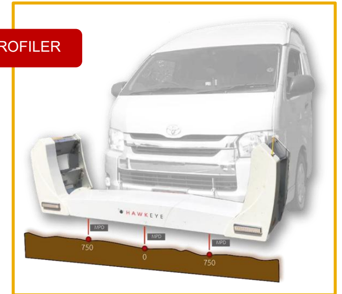
อุปกรณ์เลเซอร์ของรถสำรวจลักษณะที่ 1 ที่ใช้สำหรับเก็บค่า MPD
